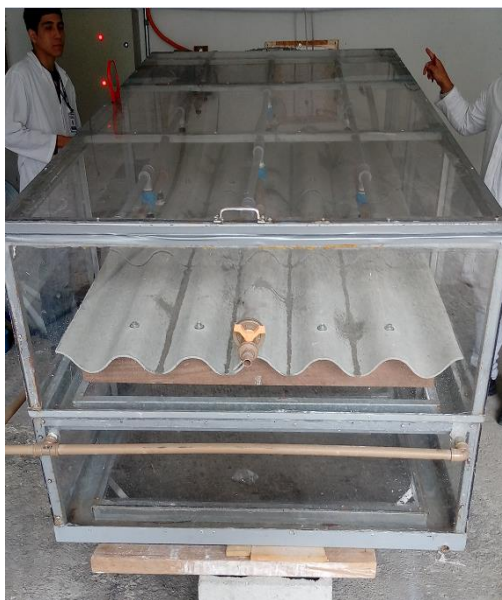
Figura 15 – Estanqueidade do sistema de cobertura – telhado submetido ao ensaio dentro da câmara de estanqueidade
