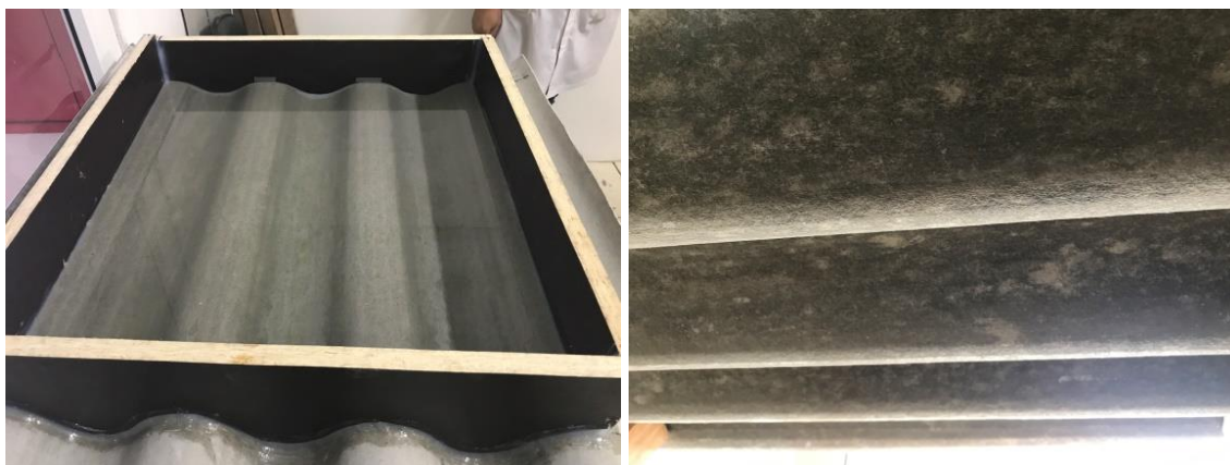
Figura 14 – Permeabilidade – telha submetida ao ensaio
