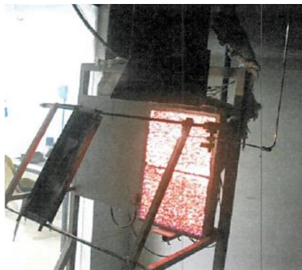
Figura 10 – Equipamento de ensaio para determinação do índice de propagação superficial de chama
