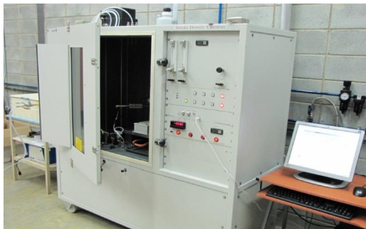
Figura 11 – Câmara e ensaio de densidade óptica de fumaça
