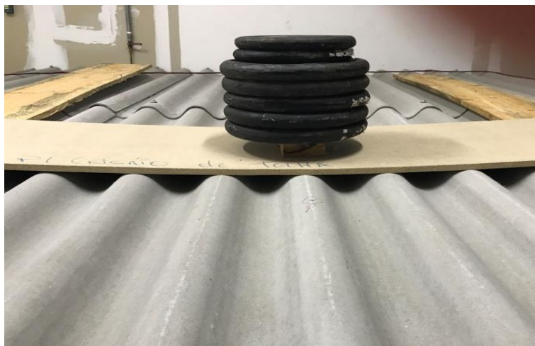
Figura 12 – Possibilidade de caminhamento de pessoas sobre o sistema de cobertura – telhado submetido ao ensaio
