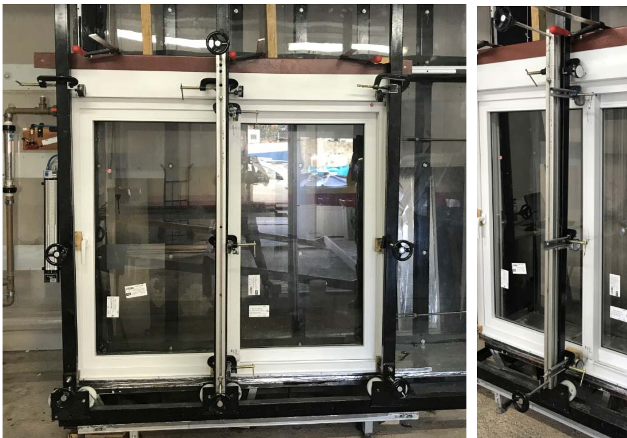
Figura 4 – Execução do ensaio de verificação do comportamento quando submetido a cargas uniformemente distribuídas
