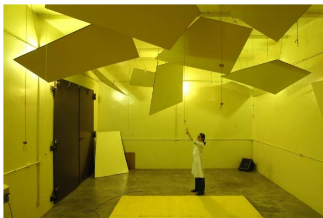
Figura 15 – Câmara de ensaio de isolamento sonora
