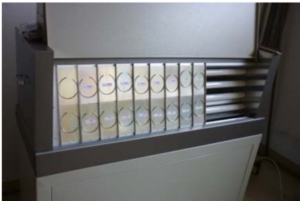
Figura 21 – Câmara CUV para avaliação da durabilidade do composto de PVC
