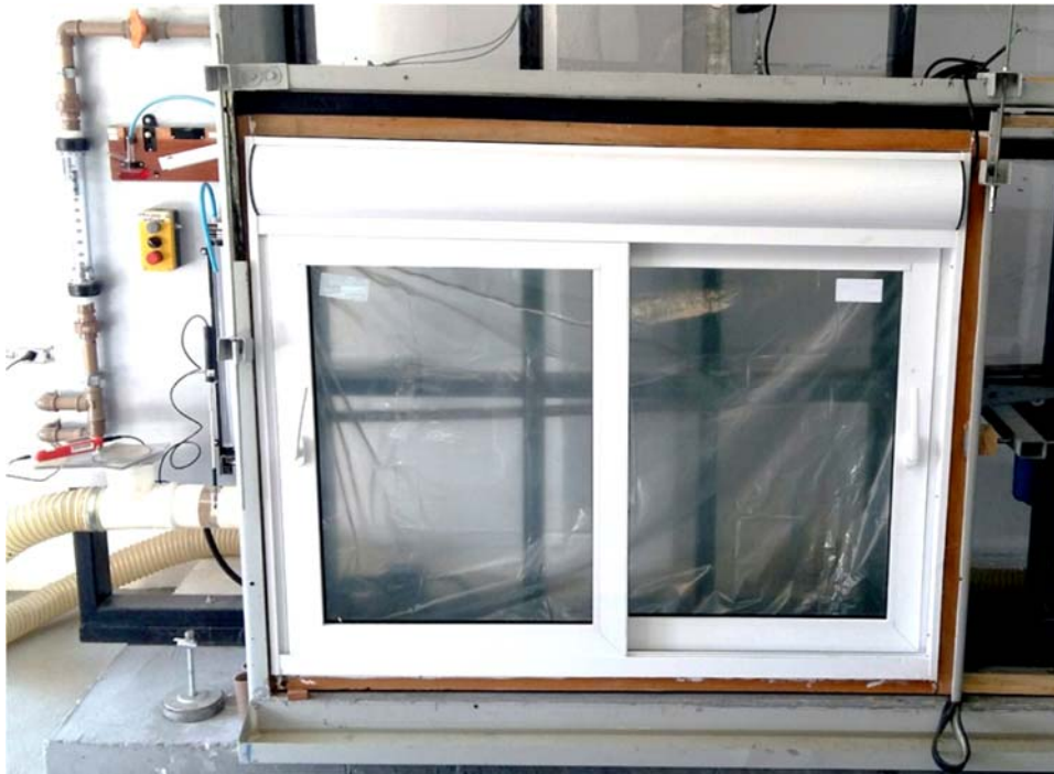
Figura 11 – Execução do ensaio de permeabilidade ao ar
