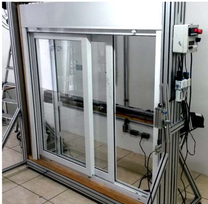
Figura 5 – Execução do ensaio de verificação do comportamento sob ações repetidas de abertura e fechamento
