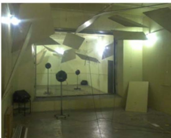
Figura 15 – Câmara de ensaio de isolamento sonora
