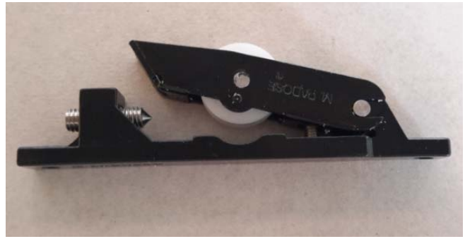
Figura 25 – Roldanas submetidas ao ensaio de verificação da resistência à corrosão
