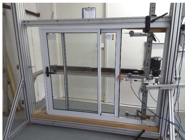
Figura 6 – Esquema de posicionamento dos relógios comparadores (esquerda) e execução do ensaio (direita)
