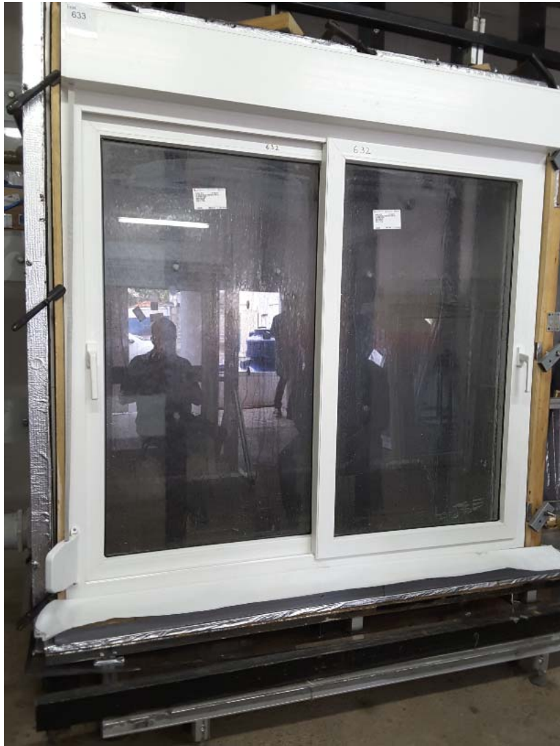
Figura 12 – Execução do ensaio de estanqueidade à água
