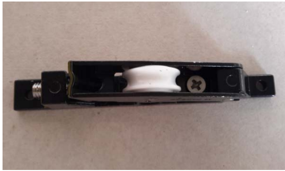
Figura 25 – Roldanas submetidas ao ensaio de verificação da resistência à corrosão
