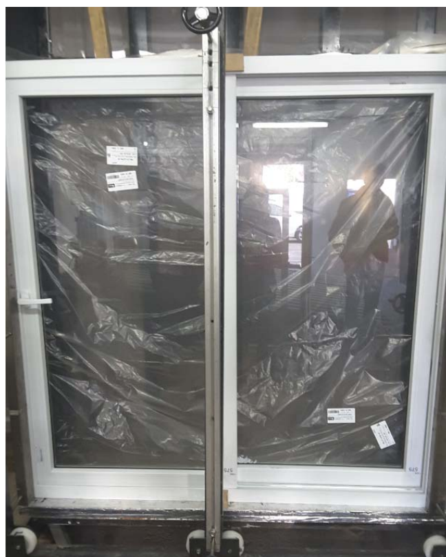
Figura 9 – Execução do ensaio de permeabilidade ao ar
