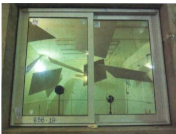
Figura 14 – Vista da esquadria a partir da câmara de emissão (esquerda) e a partir da câmara de recepção (direita)
