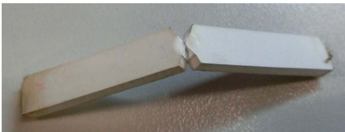
Figura 20 – Corpo de prova submetido ao ensaio de verificação da resistência ao impacto Charpy após exposição em câmara CUV
