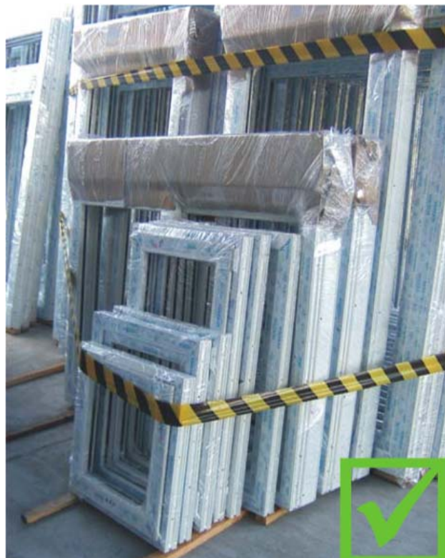
Figura 24 – Armazenamento de esquadrias de correr de perfis em PVC rígido. Imagem cedida pela WEIKU DO BRASIL
