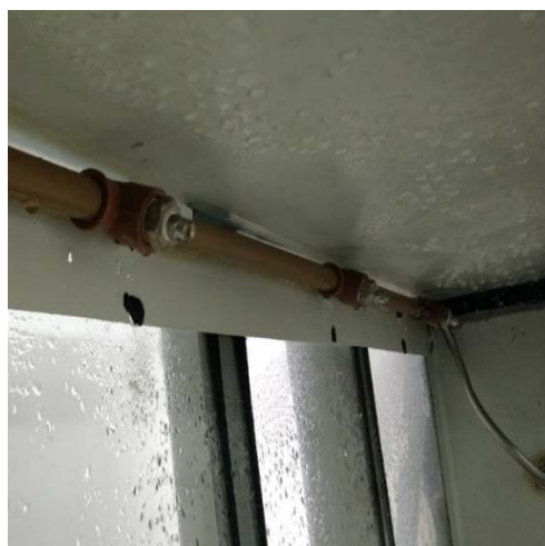
Figura 11 – Detalhe da aspersão do jato no ensaio de determinação da estanqueidade à água
