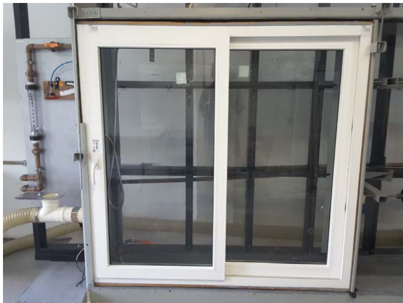
Figura 10 – Execução do ensaio de estanqueidade à água
